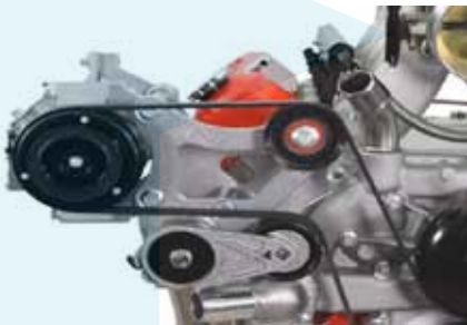
Pohon kompresoru drážkovým řemenem
