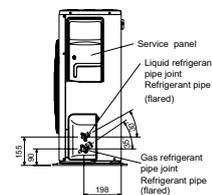
MUZ-Inverter Außengeräte, Kühlen/Heizen, MUZ-FH25-35VE
