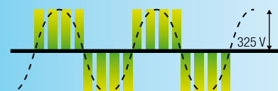
Různá frekvence při konstantním napětí 325 V.
